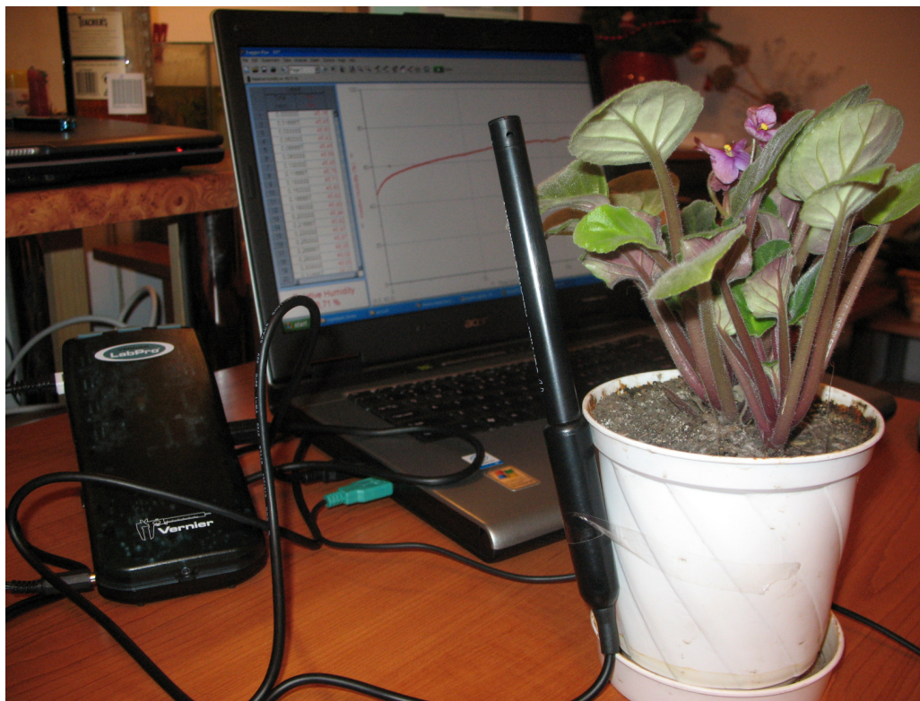
Figura 3.1 Dispozitiv experimental pentru investigarea transpirației la plante
