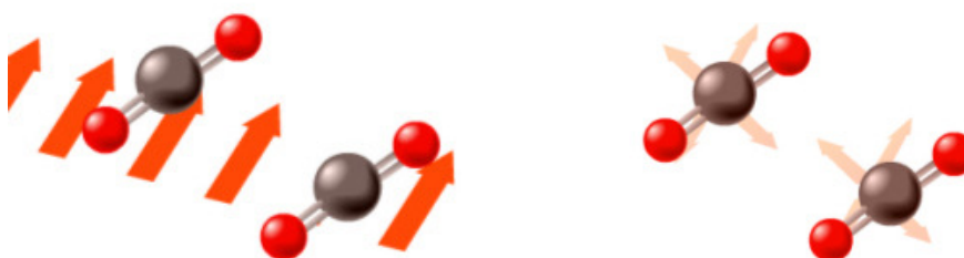
Figura 1.8 Mecanismul microscopic al absorbției și al reemisiiei radiației infraroșii
