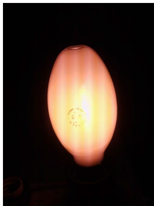
Figura 2 Emisia luminii (pe parcursul aprinderii) în cazul unei lămpi cu decărcare în vapori de sodiu
