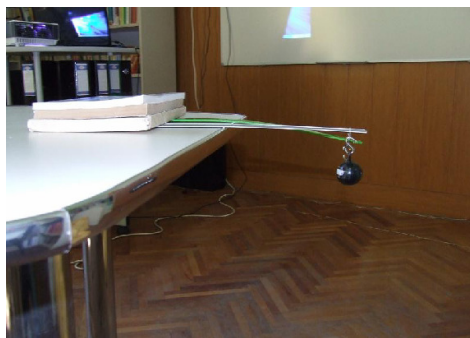
Figura 4 Analiza flexibilității riglelor cu ajutorul unui dispozitiv construit de elevi
