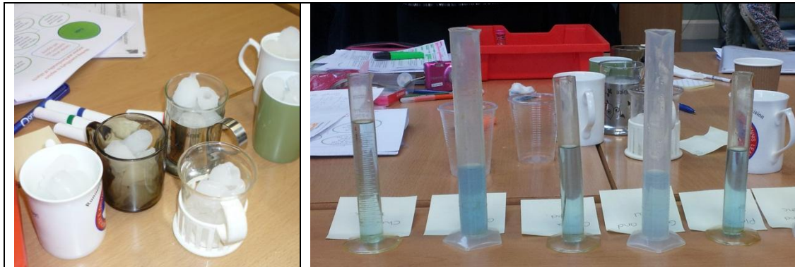
Testarea proprietății de izolator termic prin urmărirea topirii gheții
